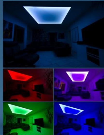
Decken-Anbauleuchten werden nach Kundenwunsch auf Maß gefertigt. Die Farbtemperatur entscheiden Sie. Wahlweise entscheiden Sie zwischen Warm -und Neutralweißtöne seitlich und vollflächige hinterleuchtet sowie der Möglichkeit einer Einfärbung des Stoffes mittels RGB-LEDs.
